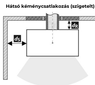
A füstcső áthaladása éghető anyagból készült falon
