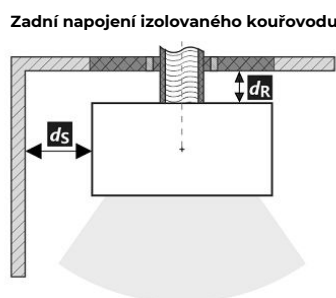
Prostup kouřovodu stěnou z hořlavé hmoty ČSN 06 1008
