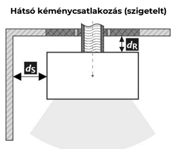
A füstcső áthaladása éghető anyagból készült falon
