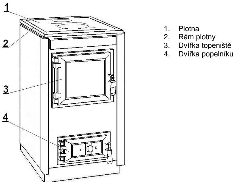
Horní pracovní plocha je tvořena ocelovou plotnou. Plášť spotřebiče je ze smaltovaných výlisků z ocelového plechu. Tepelně namáhané části spotřebiče jsou z litiny a z šamotu. Topeniště spotřebiče se nachází pod varnou plotnou s vývodem zplodin přes kouřovod. Spotřebič je napojen ke komínu otvorem na plotně.
