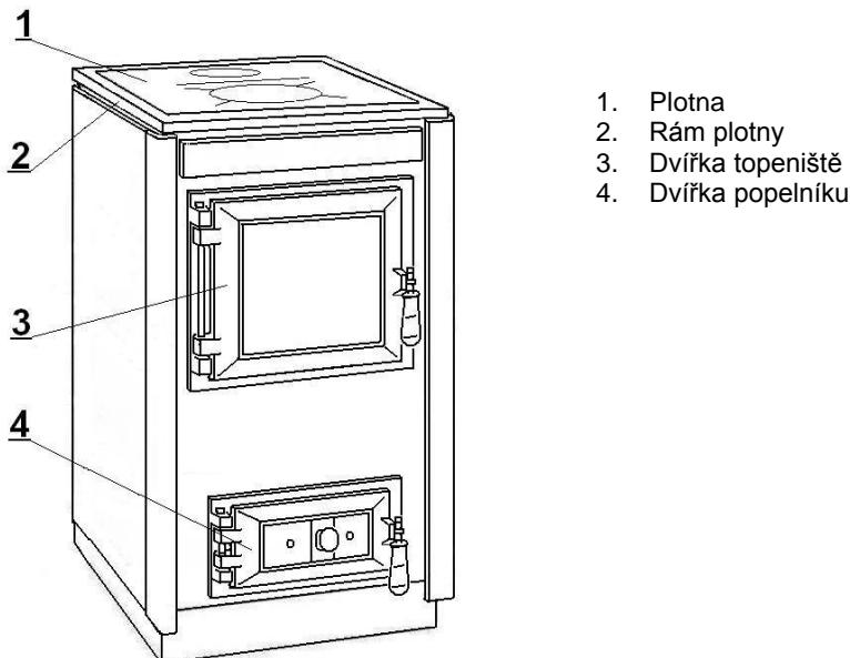
Horní pracovní plocha je tvořená ocelovou plotnou. Plášť spotřebiče je ze smaltovaných výlisků z ocelového plechu. Tepelně namáhané části spotřebiče jsou z litiny a z šamotu. Topeniště spotřebiče se nachází pod varnou plotnou s vývodem zplodin přes kouřovod. Spotřebič je napojen ke komínu otvorem na plotně.
